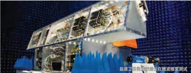
盐度卫星微波探测仪在微波暗室测试
